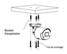
Insérez trois boulons d'expansion en place dans le plafond et fixez l'équipement avec trois vis de montage.
