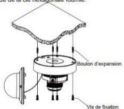
Utilisez la position indiquée sur l'autocolant de position pour percer les trous nécessaires au montage de la base de la caméra, Insérez le boulon d'expansion dans les trous. Falles correspondre les ouventures de montage de la base à la position des boulons d'expansion, puis placez les vis de montage à travers l'ouventure de montage de la base dans le boulon d'expansion. Serrez les vis de montage pour vous assurer que la base de la caméra est correctement montée.
