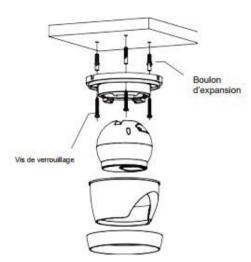
Fixez le piédestal en perçant des trous de verrouillage autour de l'autocollant en insérant trois boulons d'expansion dans les trous et en le fixant avec trois v de verrouillage.
